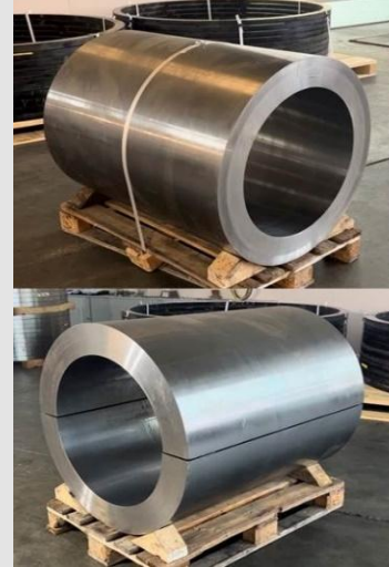
Eine Stahlbüchse präzise in zwei Halbschalen getrennt.
