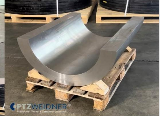
Eine Stahlbüchse präzise in zwei Halbschalen getrennt.
