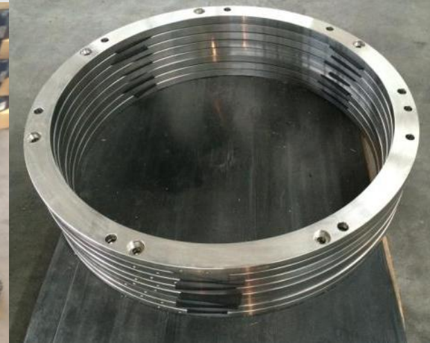
Einbaufertig bearbeitete Ringe
